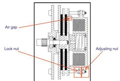
**MECHANICAL LOAD BRAKE**
